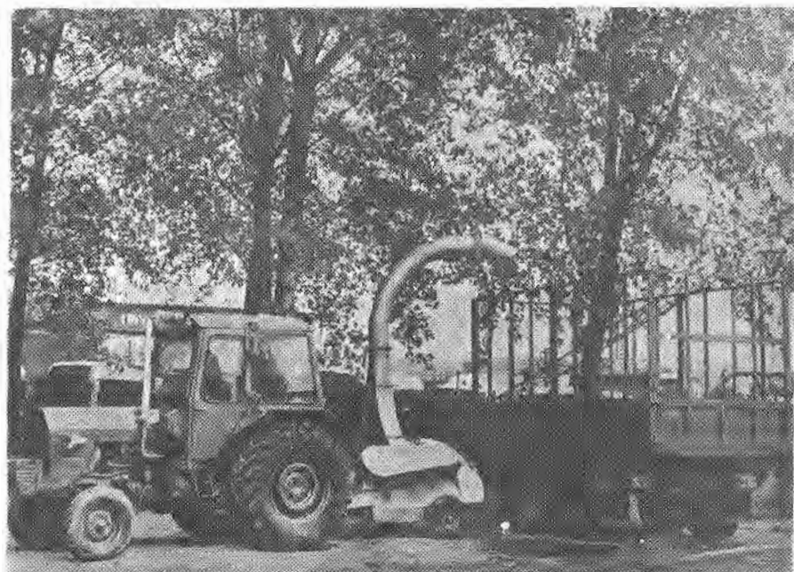
Сл. 1. Машина за иварање дрвета типа »Bruks« монтирана на погонским уређајима трактора ИМТ 858
